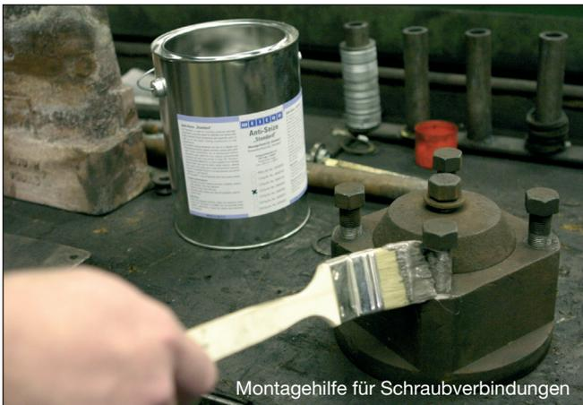
Montagehilfe für Schraubverbindungen
