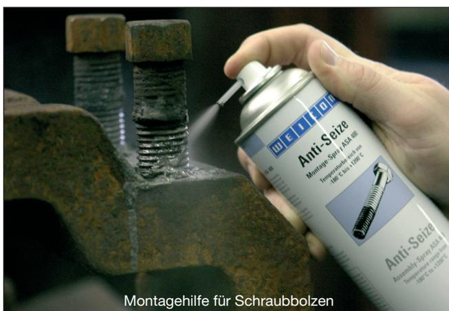
Montagehilfe für Schraubbolzen
