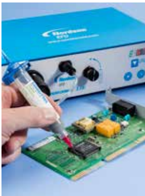
Dosierung von SolderPlus® Lotpaste auf Leiterplatten.
